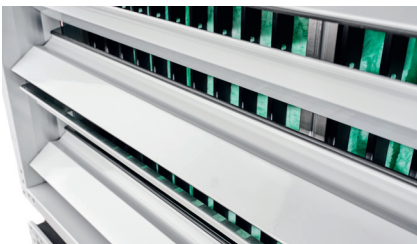
Jalousieklappen mit gegenläufig gekoppelten Alu- oder Stahllamellen und Gummidichtlippe. Luftdicht und pulverbeschichtet gemäß DIN 1946 T4.
