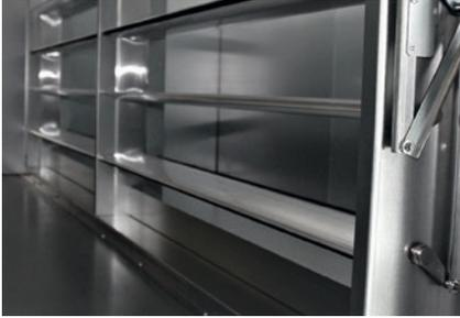
Jalousieklappen mit gegenläufig gekoppelten Alu- oder Stahllamellen, Gummidichtlippe. Auch luftdicht nach DIN 1946 T4.
