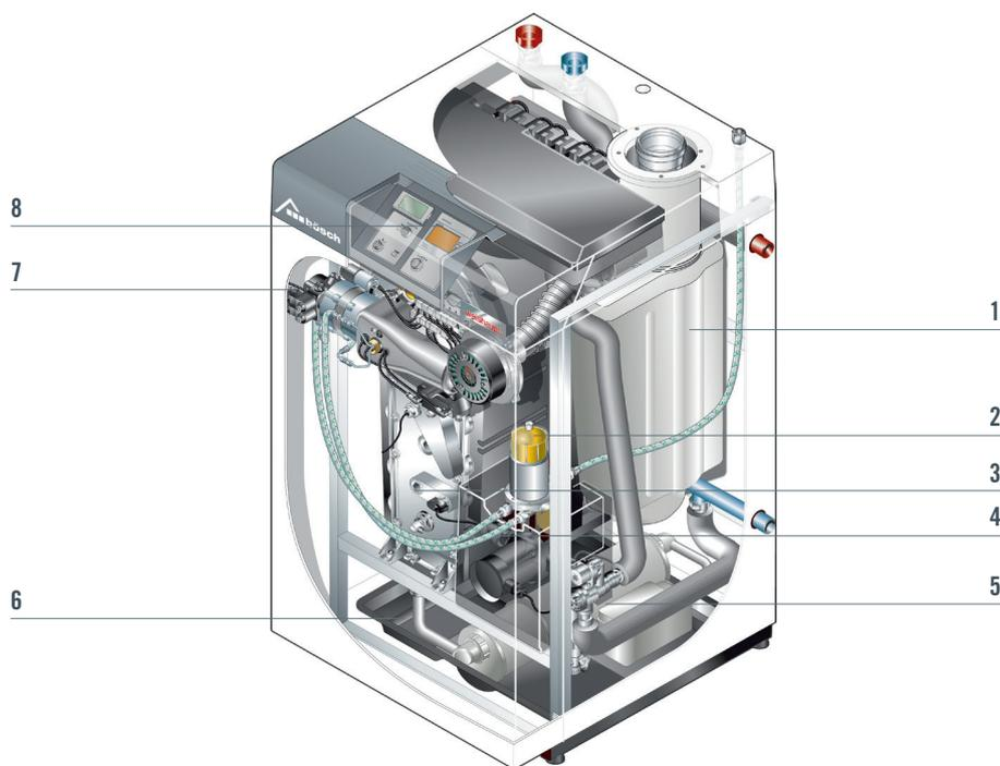
**1** Integrierter Abgas-/Zuluftgeräusch-Schalldämpfer für einen leisen Betrieb.
