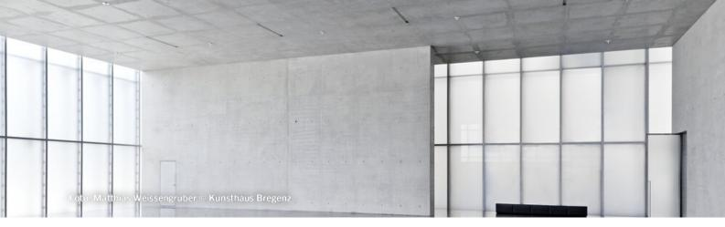
Die Regulierung von Raumklima und -temperatur ist via Bauteilheizung an die Gebäudemasse gekoppelt.
